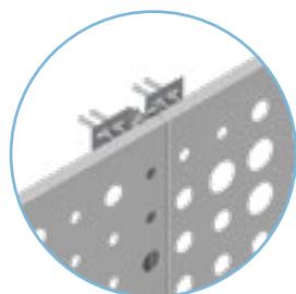
Bandejas encaixadas e parafusadas no perfil.
